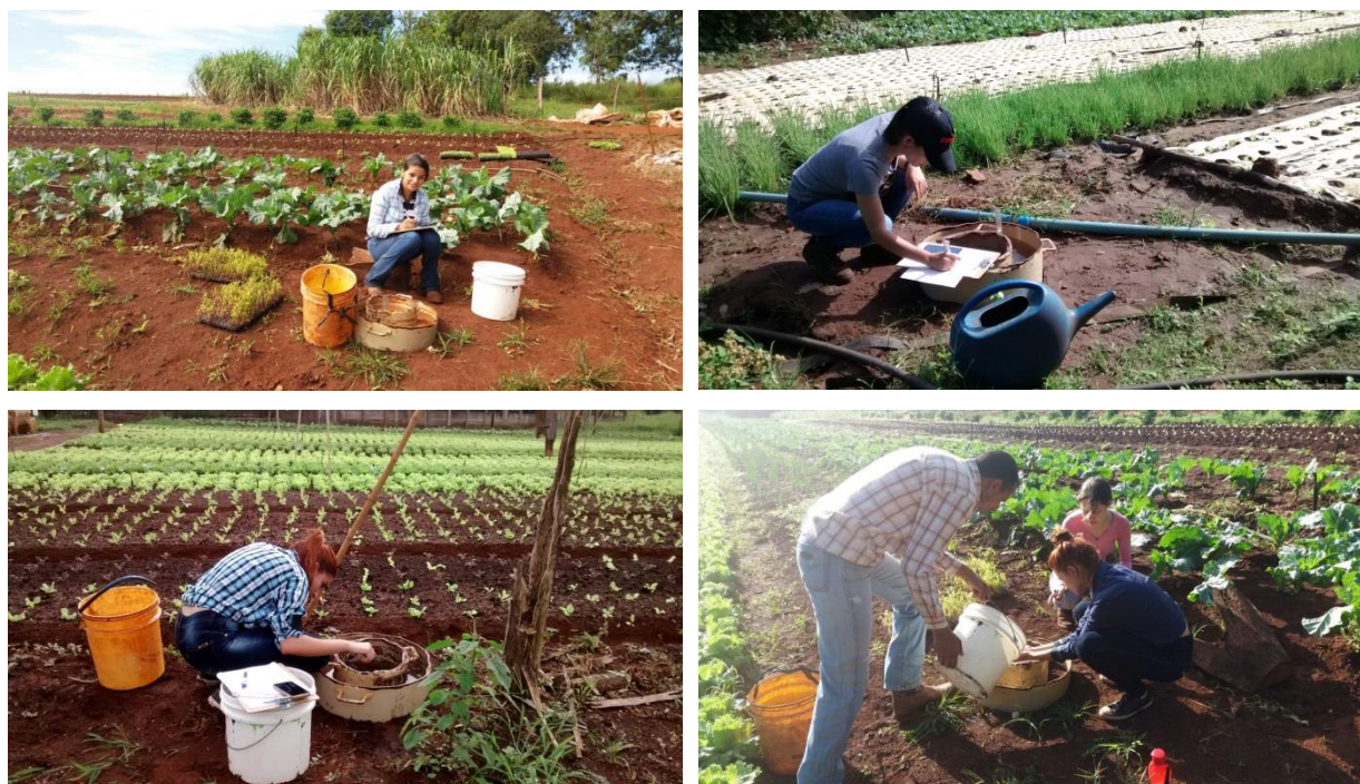
Figura 2 - Coleta de dados de taxa de infiltração de água no solo e volume de água emitida pelo micro aspersor.
